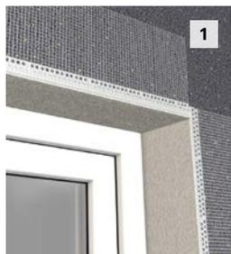
1 StoElement Pronto P-101 Laibungselement in Fenstersturz einpassen und ggf. auf Maß zuschneiden.
