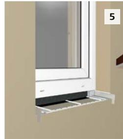
5 Auf der Rückseite des Anschraubsteigs des StoFentra Fensterbankprofils das Sto-Fugen-dichtband Lento anbringen. Das Fensterbankprofil mittig einsetzen und in das Kleberbett eindrücken.
