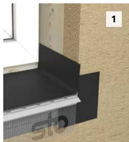
StoSeal Band AD-200 auf die Länge des Dämmkeils zuschneiden, dabei pro Seite 7 cm Überstand für die Laibungshöhe einplanen. Anschließend passgenau einkleben.
