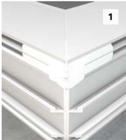
**1** Untere Diagonalnut sowie waagrecht und senkrecht verlaufende Blendrahmennut beidseitig mit StoColl Fix oder StoSeal F 100 abfugen.
