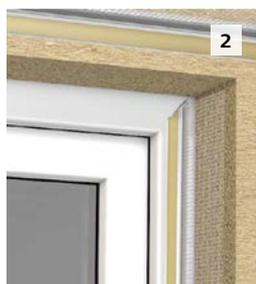
**2** Länge und Breite des Fensterblendrahmens ausmessen. Anputzleisten zuschneiden. Der Eckbereich ist dabei mit einem Gehrungschnitt auszuführen.
