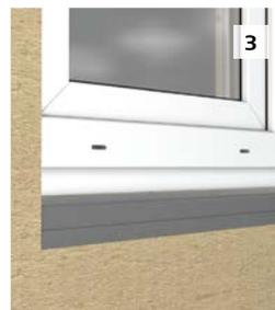
**3** Dämmkeil in die Brüstung einsetzen.
