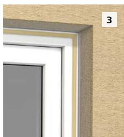
**3** Rückseitige Schutzfolie entfernen. Anputzleisten am äußeren Rand des Fensterblendrahmens verkleben. Vordere Schutzfolie entfernen und Fensterfolie aufkleben.
