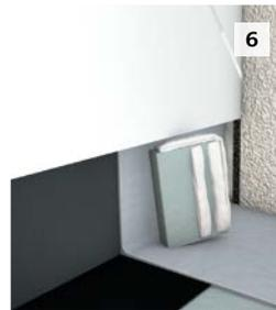
**6** StoColl Fix oder StoSeal F100 auf ein Passstück aus geeignetem Material (z. B. XPS oder Sockelplatte) aufbringen und in Gewerke Loch eindrücken.
