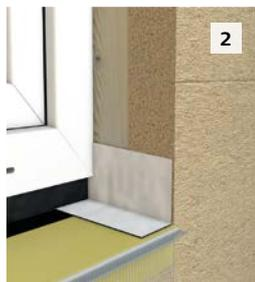
2 Seitliche Übergänge vom Dämmkeil zur Fensterlaibung mit StoPrefa E Dichtband/StoSeal Band AD-200 abkleben. Mindestapplikationshöhe an der Laibung: 7 cm.
