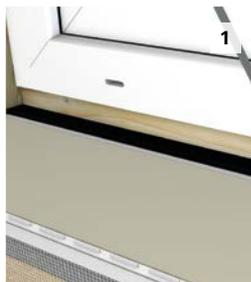
1 StoSeal Band Elast auf die Länge des Dämmkeils zuschneiden. Rückseitige Schutzfolie bis zum Folientrenner entfernen und faltenfrei am Fensterstock ankleben.
