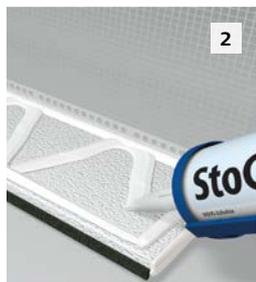
2 Sto-Fugendichtband Lento auf die Länge der hinteren EPS-Kante verkleben. StoColl Fix oder StoSeal F 100 auf die Rückseite des Laibungselements als umlaufende Kleberaupe mit eingeschlossenem V auftragen. Zusätzlich StoColl Fix oder StoSeal F 100 auf die Seitenkanten aufbringen.
