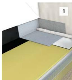
1 Kleberaube auf Dichtband und Innenecke auftragen.
