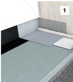
**1** Kleberaube auf Dichtband und Innenecke auftragen.
