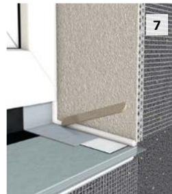
**7** Plattenstöße und Übergänge mit StoColl Fix oder StoSeal F100 vollständig ausfugen und glatt streichen.
