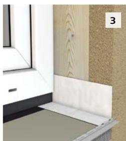
3 Seitliche Übergänge vom Dämmkeil zur Fensterlaibung mit StoPrefa E Dichtband abkleben. Mindestapplikationshöhe an der Laibung: 7 cm.
