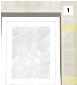
Gewebefahnen des Dämmkeils und der Laibungselemente sowie die Diagonalarmierung vollständig in die Armierungsschicht einarbeiten. Fläche armieren.
