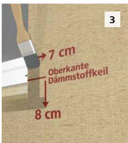
**3** Zur Verbesserung der Haftung für den StoElement FG Corner ist die Oberfläche im vorderen Eckbereich mit illbruck ME904 zu verfestigen.
